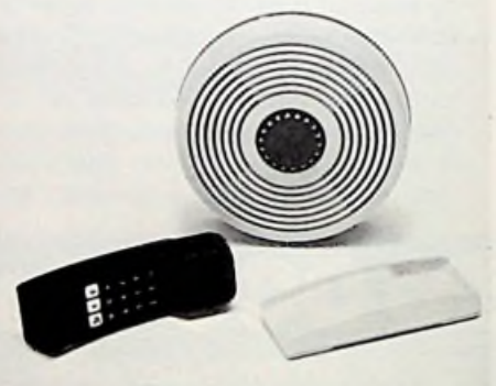
Bild 1. Infrarothörer mit Hörerablage und Wandstation im Hintergrund
